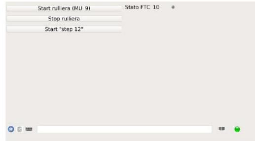
Sur la droite se trouvent les indicateurs d'état relatifs aux capteurs de cette section : cellule photoélectrique d'entrée (FTC10).
