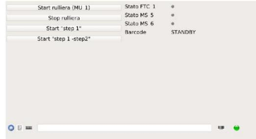
A la derecha se encuentran los indicadores de estado relativos a los sensores de esta sección: fotocélula de entrada (FTC1) y los dos microinterruptores de lectura codificación binaria del transportador (MS5-MS6).
