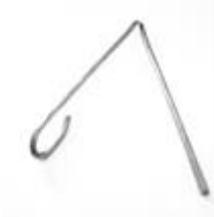
Herramienta fina o destornillador plano de 2,5 mm (para limpiar los inyectores de las bases, en su caso)
