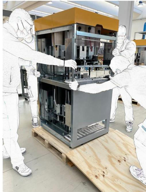
Emplazar la máquina en el lugar de instalación previsto, sobre una superficie adecuada para sostener el peso o sobre una pavimentación plana y lisa.
